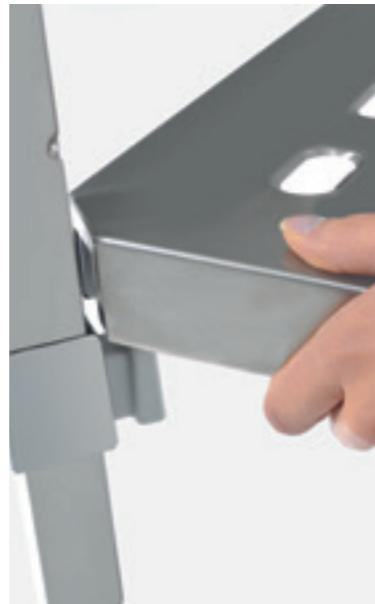
Scaffalature in alluminio composto da montanti in tubo alluminio Ø 35 mm, traverse in alluminio 40x30 sp. 2 mm, ripiani in polietilene resistenti alle basse temperature smontabili e lavabili con facilità.
